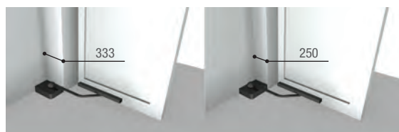
Наземная установка привода в стандартном положении
